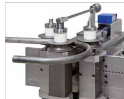
Biegen von 1" Rohr
