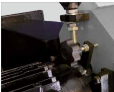
Spannen / Ausrichten des Schleifbandes
