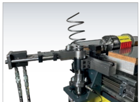
Spirale Freiform und biegen mit Steigung
