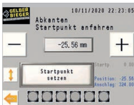
Anfahren des Startpunktes mit + Taste
