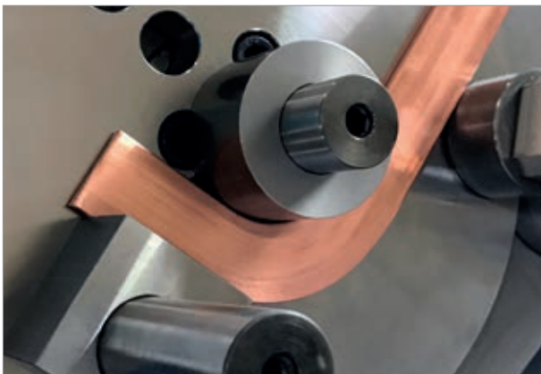
Flacheisen auf Kante 30 x 6mm
