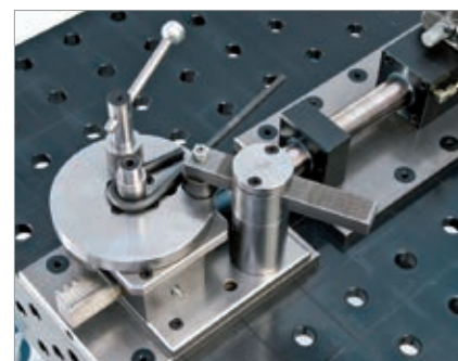
Hakenbiegen aus Rundmaterial
