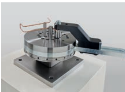
Biegen über dem Werkzeug
