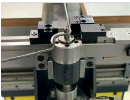
Drahtbiegen im Uhrzeigersinn
