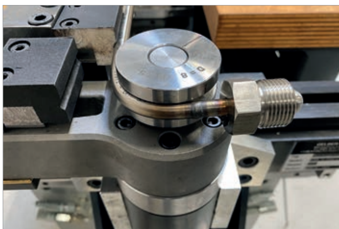
Biegen mit montierter Verschraubung
