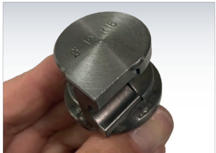
Biegewerkzeug mit Spannfläche
