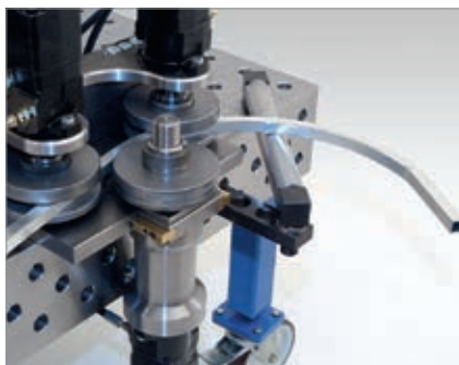
Biegen von Alu 25 x 25 mm Rohr
