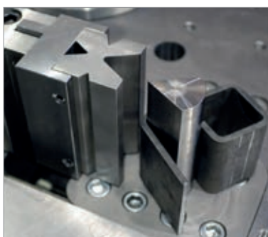
Biegedorn für enges Biegen
