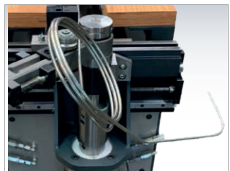
Freiformbiegen kombiniert mit Biegen
