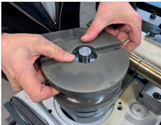
Biegewerkzeug wechseln
