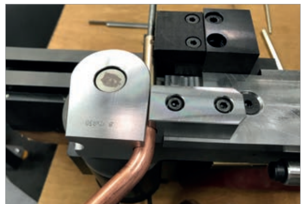
Kupferrohrbiegen mit Dorn
