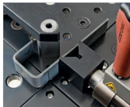
Kanten von Flacheisen 60x8 mm
