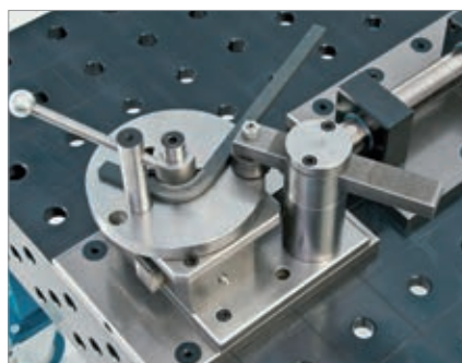
Aufwickeln von Flacheisen liegend
