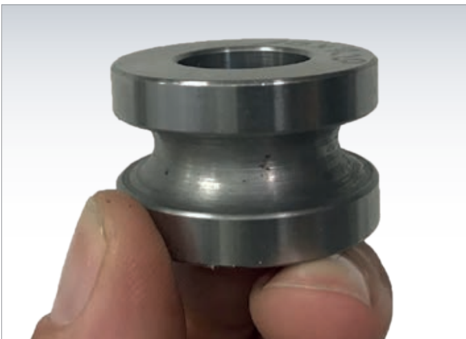
Biegewerkzeug ohne Spannfläche
