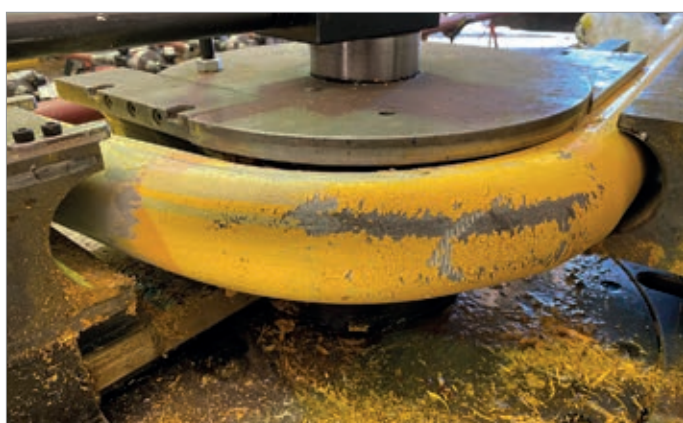
Biegen von lackierten Fernwärmerohren
