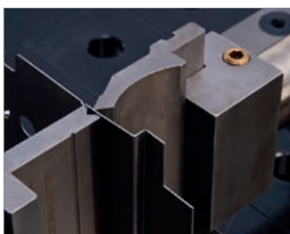
Biegen mit Stempeladapter und T - Matritze
