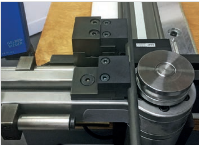
Biegen gegen den Uhrzeigersinn
