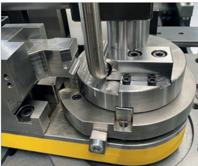
Biegen von Vollmaterial \varnothing 16 mm Radius 22 mm
