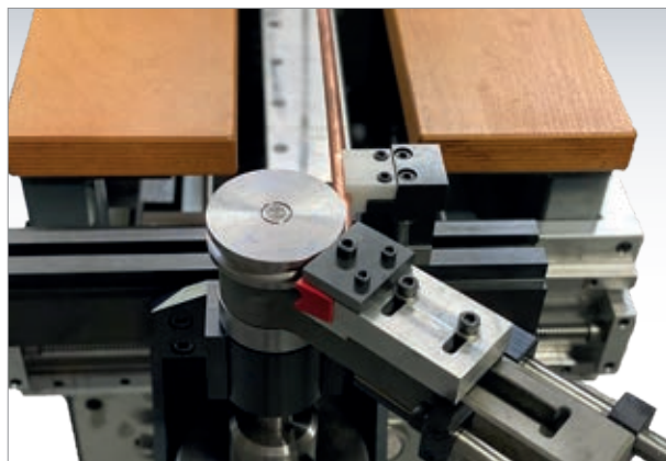
Kupferbiegen mit Gleitschuhtechnik
