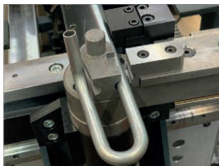
Biegen mit Booster 1,2 x D
