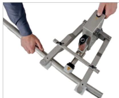
Biegen von Rohr 42 mm
