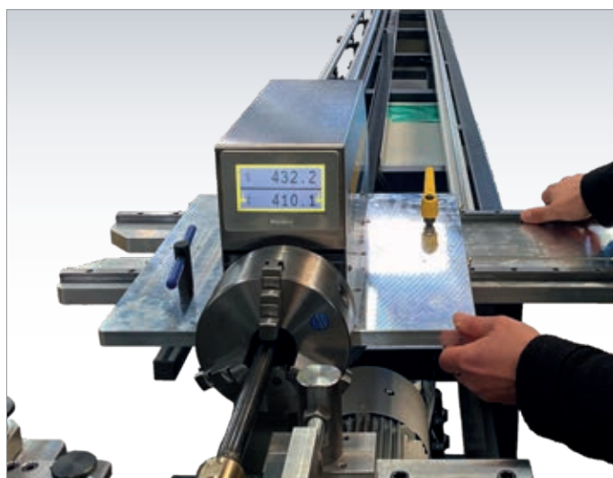
Manuelle Positionierung (Die Anzeige zeigt die Ist-Soll Position)
