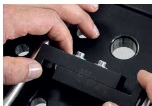
Einsetzen der Abstandslehre
