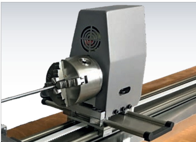
Antrieb für Länge und Verdrehung
