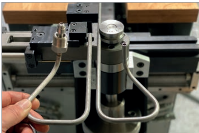
8 mm Edelstahl Rechts- / Links-Biegen
