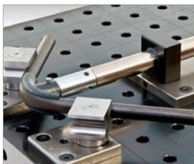
Rohrbiegen durch Drücken
