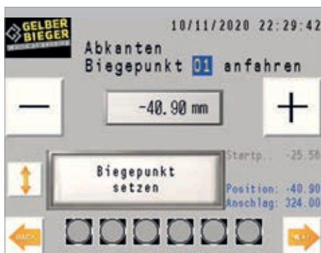
Anfahren des Biegepunktes mit + Taste
