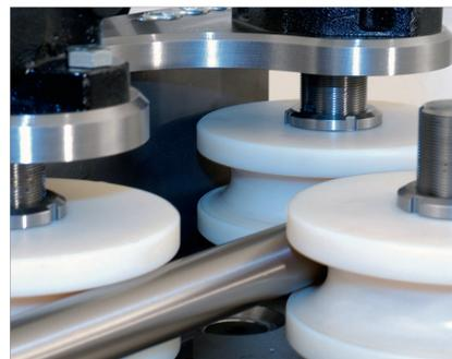
Polyamidwalzen und VA Rohr
