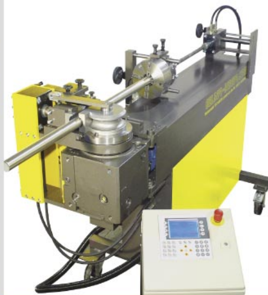
Tüskés hajlítógép – Géptípus: S-50 2m-es tüskeszárral
