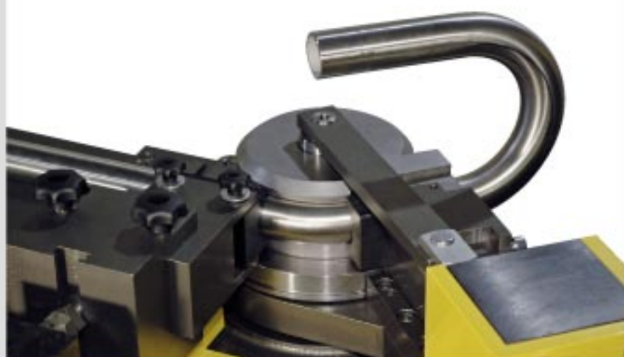
Hajlítófej csúszórúddal, szorítópofákkal, hajlítóformával és csővel D= 42 mm
