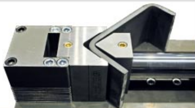
Maximális hajlítási kapacitás: 100x15 mm (125 mm-es matricában)
