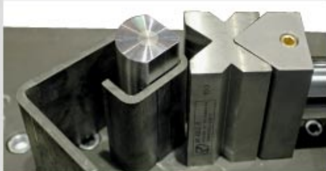
Szelvény hajlítása (50 x 50 mm) hajlítótűske körül
