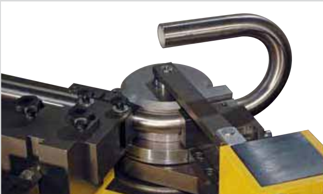
Головка гибочного станка с направляющей планкой, зажимными устройствами, гибочным штампом и трубой диаметром 42 мм
