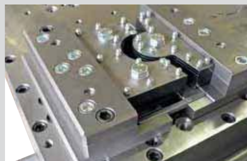
Загибный участок для кромки: высота загиба 165 mm (возможно увеличение до 200 mm)
