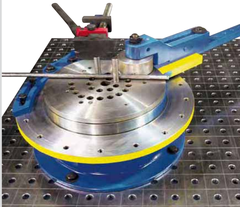
Универсальный ручной гибочный станок Для гибки прутка, круглого материала и труб диаметром до 33 мм.
