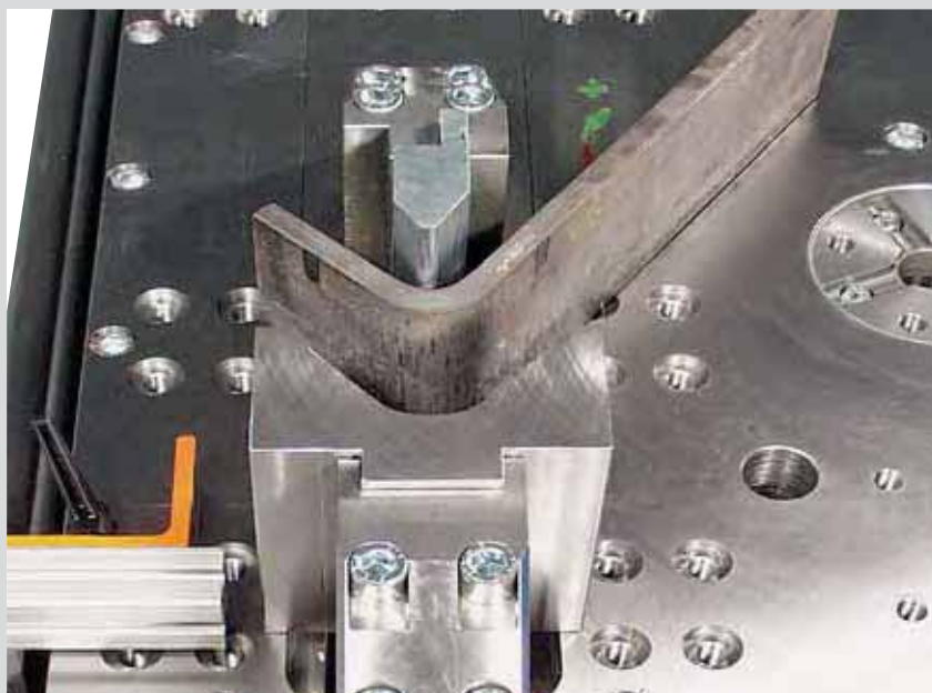
Загибный участок для кромки: высота загиба 165 mm (возможно увеличение до 200 mm)
