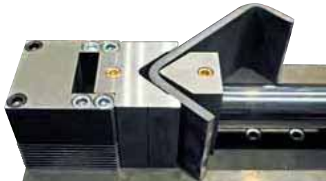
Максимальные возможности гибки 100х15мм, глубина матрицы 125мм
