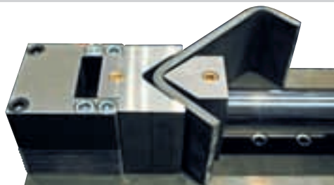
Maks. zdolność gięcia 100 x 15 mm w matrycy 125 mm
