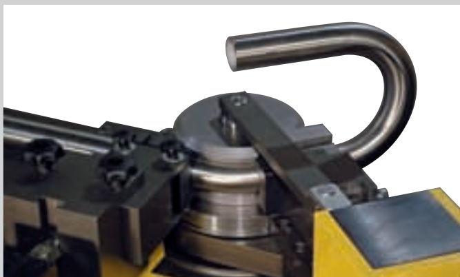
Głowica gnąca z prowadnicą, zaciskiem, szablonem do gięcia i rurą d=42 mm
