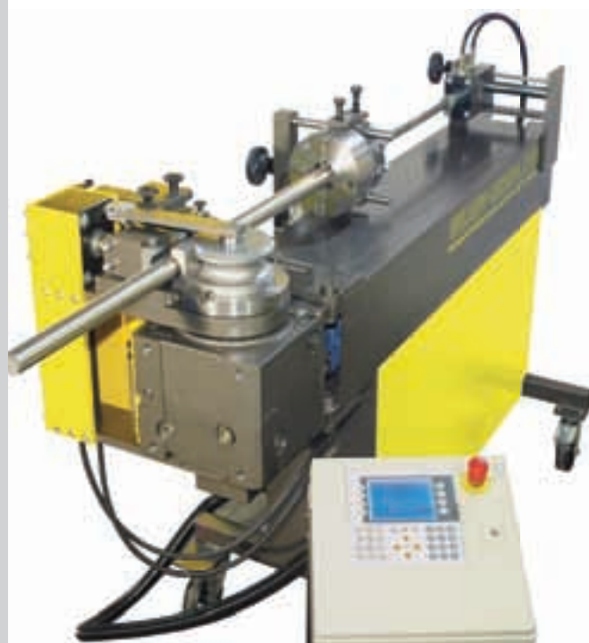
Giętarka z rdzeniem typ S-50 z posuwem 2 m rury
