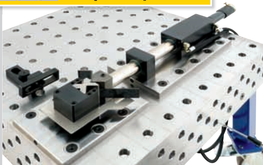
Giętarka z matrycą V80, stempel w uchwycie matrycy
