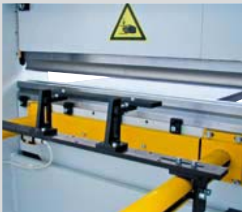
Butée arrière électrique – commandée de l'avant
