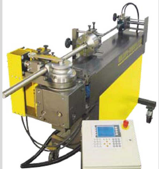
Cintreuse à mandrin type S-50 avec tige mandrin de 2 m
