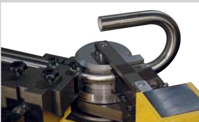
Buigkop met geleider, spanklemmen, buigsjabloon, buis D = 42 mm
